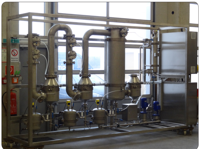
Dreistufige Entschwefelungsanlage für 500 m 3 /h Biogas mit 99+% H_2S -Abscheideleistung
