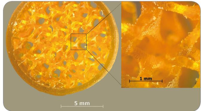
3D gedruckte zelluläre Polymerstrukturen
