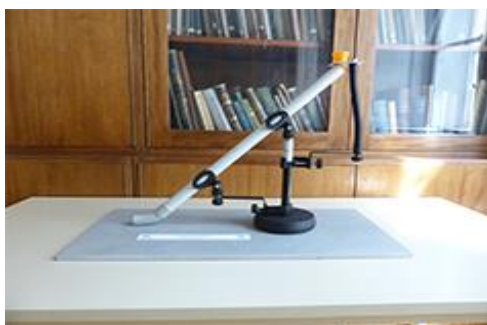
Abb.: Prototyp des Boden-Gleitprüfers der TU Wien mit einer Höhe von ca. 20 cm. Das Streumuster zeigt die Rutschfestigkeitsklasse des Bodens.
