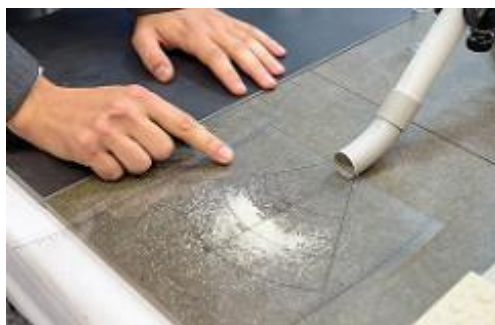
Abb.: Prototyp des Boden-Gleitprüfers der TU Wien mit einer Höhe von ca. 20 cm. Das Streumuster zeigt die Rutschfestigkeitsklasse des Bodens.
