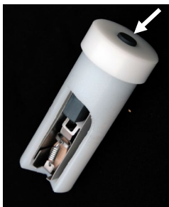
Abb. links: Prototyp entriegelt und hohe Feuchtigkeit; Der Feuchteindikator ist in den frischen Estrich eingebaut, Indikator auf zweiter Stufe, sichtbar (Pfeil)
