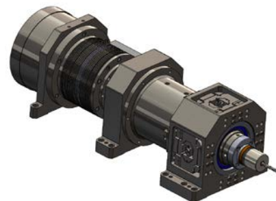
Fig 1: Schwingspindelkonzept mit schwingfähiger Rotorwelle in drei Achsen
