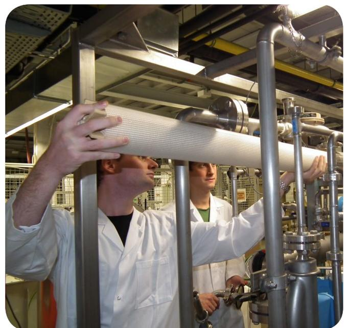
Bestückung der Pilotanlage mit Nanofiltrations Membran
