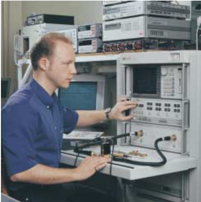
Test der Verstärker auf einem automatischen S-Parameter-Meßplatz.
