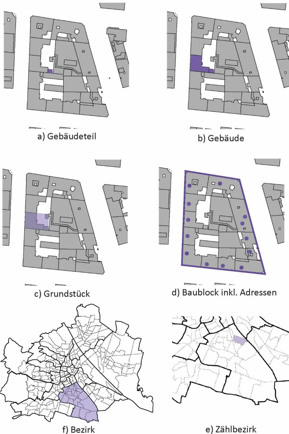
Abbildung 4(a) zeigt den Gebäudeteil als kleinste räumliche Einheit, die im Projekt M-DAB analysiert und für die Berechnungen in der Simulation herangezogen wird. Die Grundfläche der Gebäudeteile
