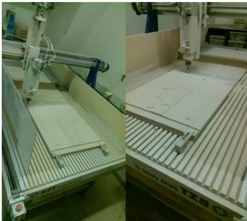
Abbildung 35: Geländeausarbeitung mittels CNC-Fräse
